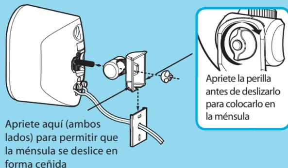
**Ajuste del ángulo de inclinación en la pared**
