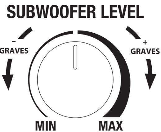
El conmutador **LEVEL** (Nivel) del subwoofer está ajustado a 0 grados para adaptarlo a las preferencias promedio. Si lo desea, ajústelo para adaptarlo al nivel de sonido de sus altavoces.
