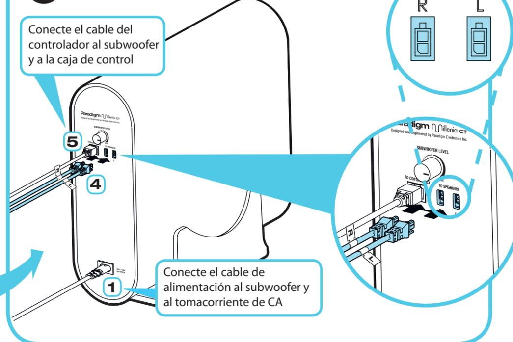
Conecte el cable del controlador al subwoofer y a la caja de control
