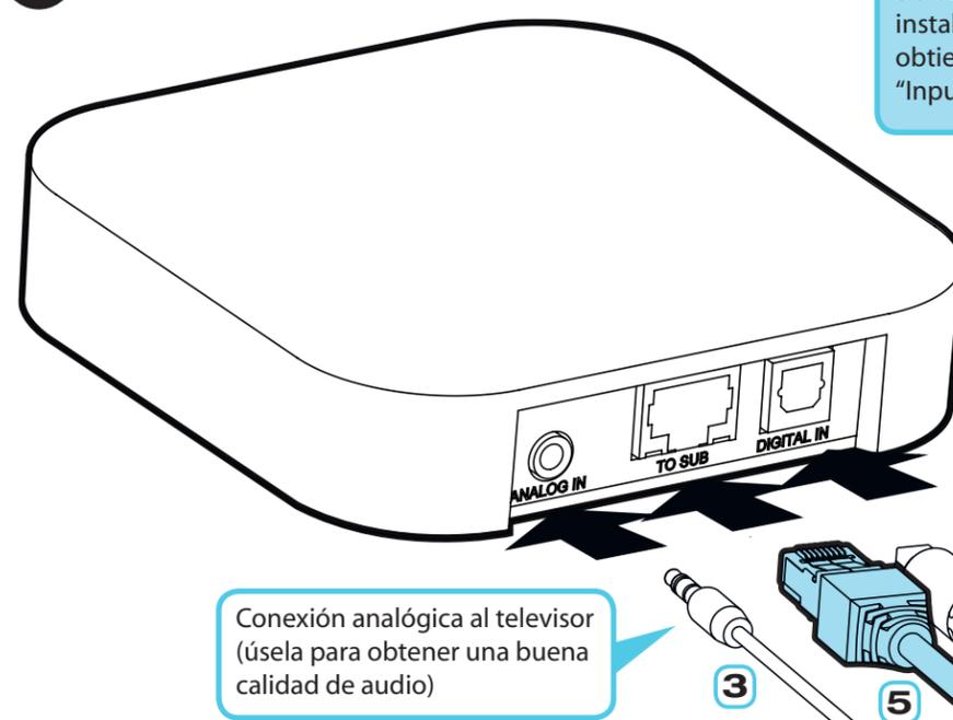
Conexión analógica al televisor (úsela para obtener una buena calidad de audio)
